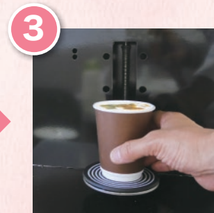
3 印刷が終わると、自動でカップ が元の位置に戻り、出来上がり。
